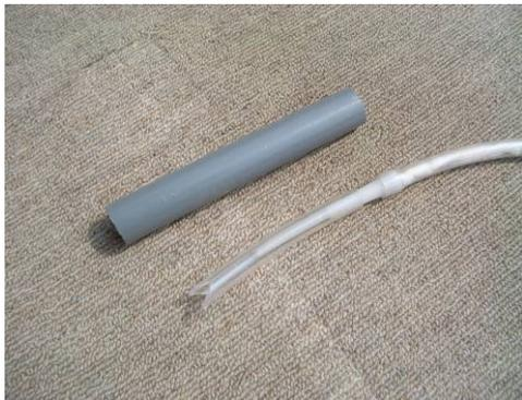
写真7(内径 1.5~2.0cm の塩ビ管を用意する)
