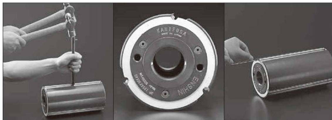
替刃交換の手順(モルダー用)…サイドセット方式
