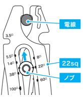
ノブを移動させ、電線が前方に 寄った状態で計測する。
