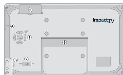
①操作ボタン(十字キー) ②電源スイッチ (ON / OFF) ③DC IN 電源プラグ
