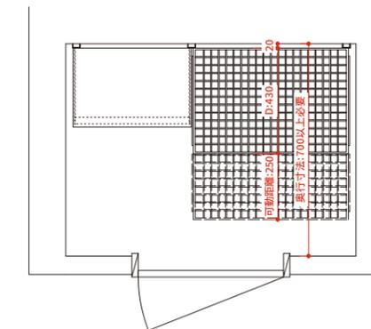
例) 左図のレイアウトでは壁からの距離20mm、パーツ奥行(スライドバスケット)430mm、可動距離250mm、3つの合計が700mmとなるため、収納内部の奥行寸法は700mm以上必要。
