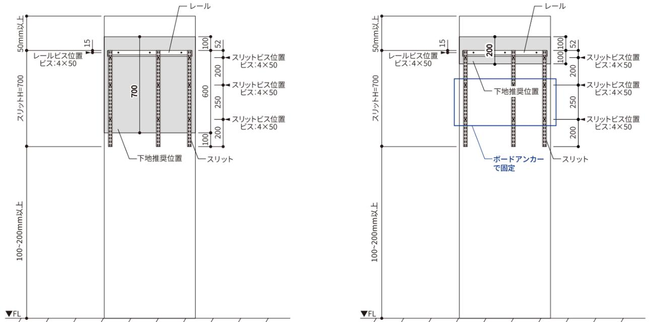
図中□部分は必ず下地を入れてください。その場合は、残りのビス穴はボードアンカーで固定してください。
