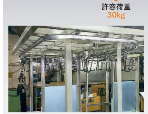
**ベンダークリップ付天井ブラケット** (レールを鋼材に取付ける場合に使用)
