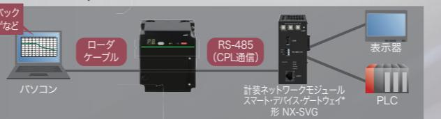
\*各種制御デバイス間の情報連携をプログラムで実現し、開発作業をスマート化することができる通信ゲートウェイのこと
