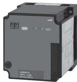
バーナコントローラ 形 AUR890は、形 RA890のリブレース専用に開発した、バッチ運転専用(24時間以内に1回以上発停する装置)の燃焼安全制御器です。アドバンスUVセンサ 形 AUD100/110/120やフレイムロッドと組み合わせて使用し、ON/OFF制御のガスバーナやオイルバーナの点火、火災監視、燃料の遮断を自動で行い安全を確保します。
