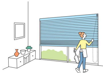
1本のチェーンで、スラットの角度調整と製品の昇降が行えます。
