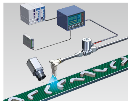
水切りなどのエアブロー・ 定流量制御(流量センサフィードバック)
