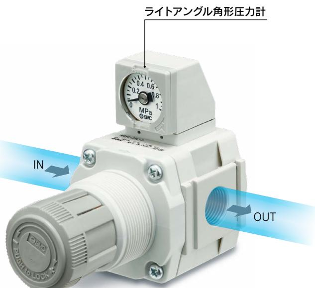
配管方向に応じて、90°毎に圧力計の目盛板向きを変更可能
