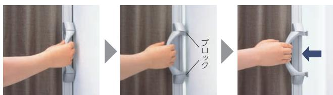
取手を引くと内部から出るブロックが壁を押してマグネットから外れる力を軽減します。
