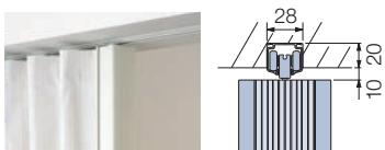
レールを取付け面に埋込む場合に。
