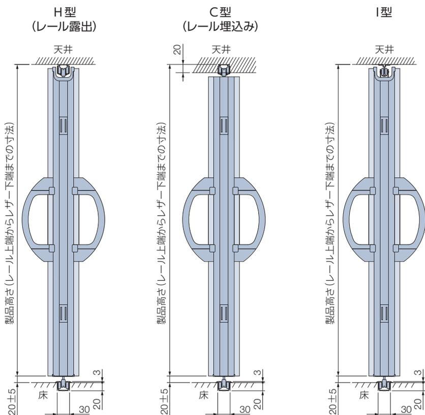
下ガイドレールの床面への埋込み寸法は、20mmです。
