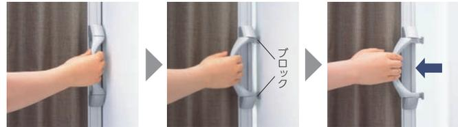
取手を引くと内部から出るブロックが壁を押してマグネットから外れる力を軽減します。標準取手より軽い力で開けることができます。
