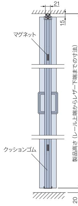
取手の高さ (製品下端から取手下端までの寸法)
