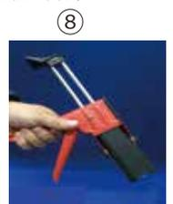
PMまたはPM15(主剤+硬化剤)のキャップを図のように回転させながら外します。 ※キャップを外したP MまたはPM15(主剤+硬化剤)の先端にMX-G(ノズル)を装着しセット完了です。
