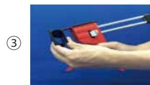
セット完了したP G (充填機) P MまたはPM15(主剤+硬化剤)を準備する。
