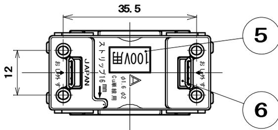
適用電線：銅単線 φ1.6mm、φ2mm
