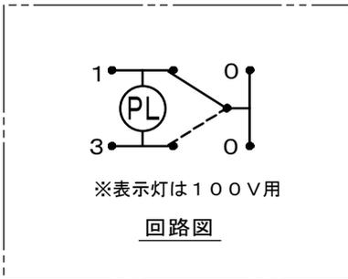
適用電線：銅単線 φ1.6mm、φ2mm
