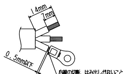
※圧着端子のかしめは  $\left\{ \begin{array}{l} 3.5 \text{ mm}^2 \text{ は } 540 \text{ N} \\ 5.5 \text{ mm}^2 \text{ は } 780 \text{ N} \end{array} \right\}$  1分間の張力に耐えること。
