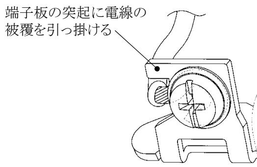
4-2-4 コードグリップねじを締め付ける。(適正締付トルク 0.5 N·m~0.8 N·m)
