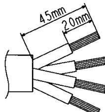
4-2-3 端子ねじを締め付ける。(M4:適正締付トルク 0.9 N·m~1.2 N·m)
