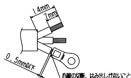
※圧着端子のかしめは  $\begin{cases} 3.5 \text{ mm}^2 \text{ は } 540 \text{ N} \\ 5.5 \text{ mm}^2 \text{ は } 780 \text{ N} \end{cases}$  1分間の張力に耐えること。
