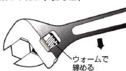
ボルト・ナットを回すときには、必ずモンキレンチをボルト・ナットに直角の形で、平行に回してください。(図2参照)ボルト・ナットを少し押し付けるようにして回すと、外れにくくなります。
