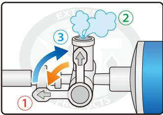
バルブを一度横に寝かしエアが抜けたのを確認し、再度直立の位置へ戻す。
