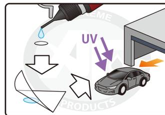
仕上げレジンを一滴たらしフィルムで遮断後、紫外線の当たる屋外へ車両を移動させ
