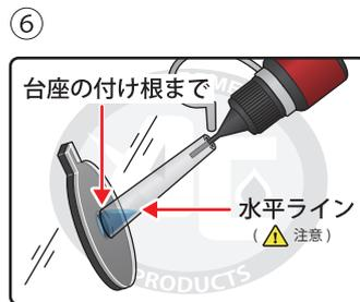
⑥ 容器の注入口を台座に差し込み、レジン液が水平ライン(上図)に来るまで注入する。
