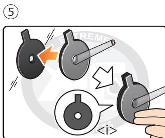
⑤ 台座をシールに貼り合わせる。全体を指で軽くなぞって完全に密着させて下さい。貼り合わせて車内より確認すると<i>の図のようになります。
