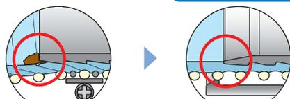
継手先端とホースの間に流体残留物が溜まる場合がある。
