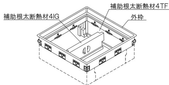
3. 中蓋断熱材を設置します。
