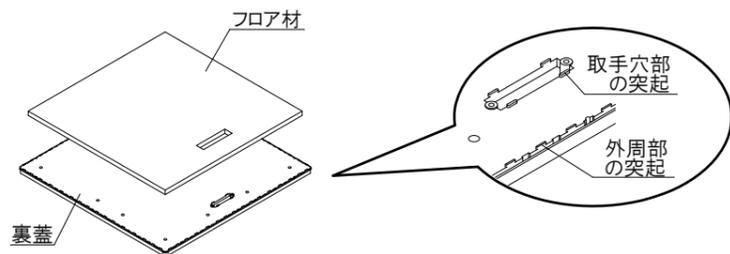
裏蓋の外周と取手穴部の突起の上にフロア材が乗り上げないように注意してください。がたつきの原因になります。
