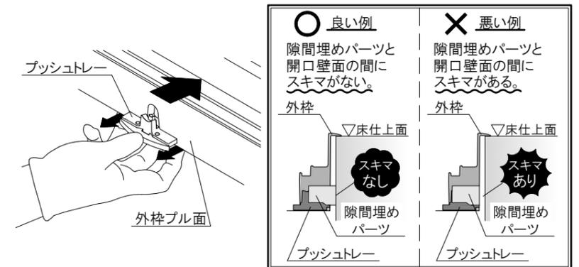
作業後、外柾と開口壁面の間にスキマがないことを確認してください。スキマがある場合は外柾プル面を開口壁面側に押すと動くので、もう一度やり直してください。そのまま取り付けると外柾が変形するおそれがあります。
