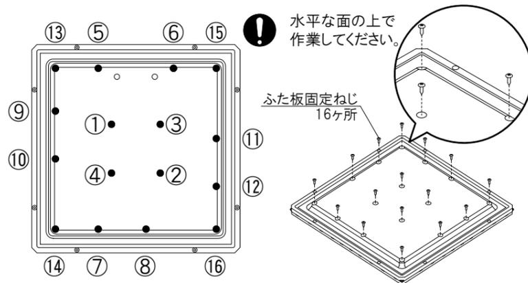
電動ドライバーを使用される場合は、トルクを小さくして取り付けてください。
