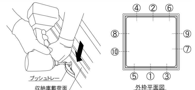
外柾と床仕上面の間にスキマができないように施工してください。
