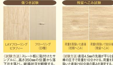
(試験方法) スレート板に貼付けたサンプルに、高さ350mmの位置から落下片を落とし、破壊状況を観察する。
