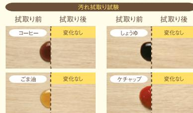
(試験方法) 床材表面に各種調味料を塗布。24時間後拭取り表面の状態を評価する。
