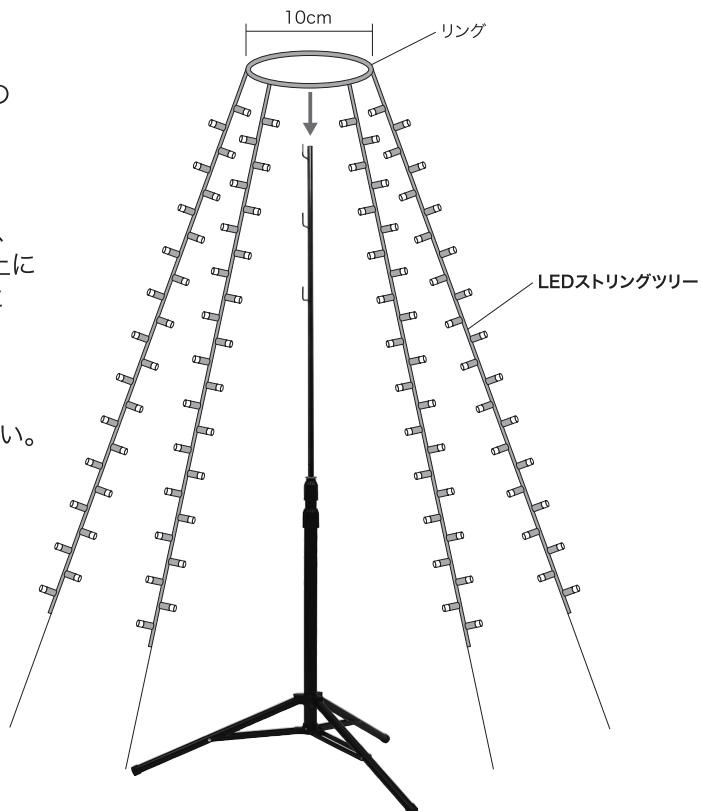
**⚠** LEDストリングツリーは偏らないように取付けてください。偏って取付けるとバランスが崩れ三脚スタンドが倒れます。必要に応じてLEDストリングツリーや三脚スタンドを地面に固定する等、転倒防止の対策を行ってください。
