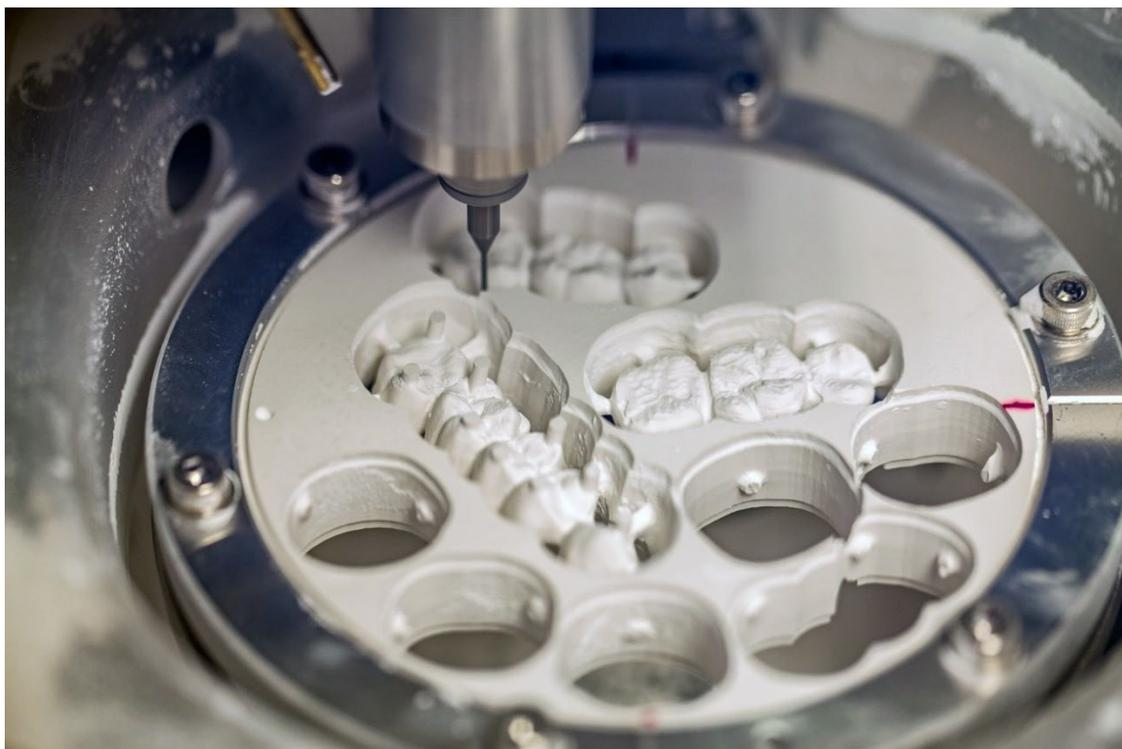
▲ディスクと呼ばれるワークから補綴物を自動で削り出します
