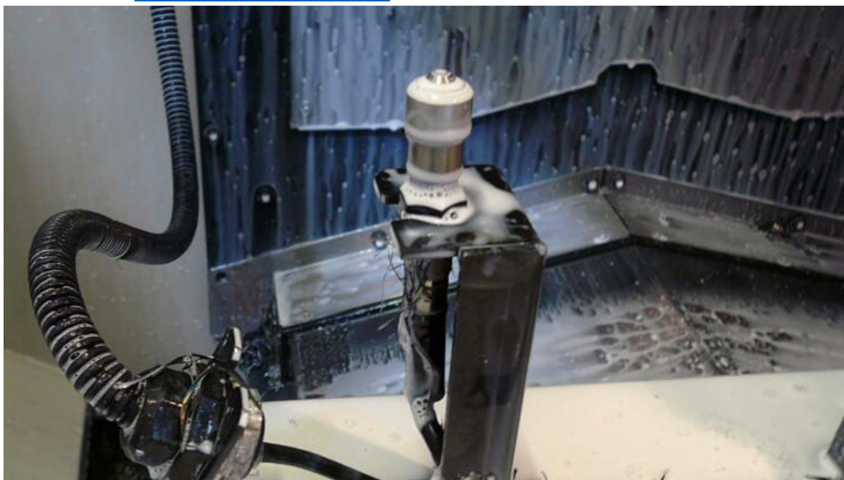
▲クーラント、切粉がかかる悪環境下、ドリルの『原点出し』を行う マシニング用ツールセッタシリーズ
