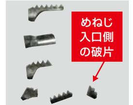
注) ハンドタップやポイントタップのような直溝のタップは、加工が深くなるほどタップのランドがたわみやすくなり、タップの破片が発生しやすい。そのため、除去途中で異音が生じて、タップの破片が発生した際は加工を止めて、破片をけがき針などで取り除きながら慎重に加工してください。
