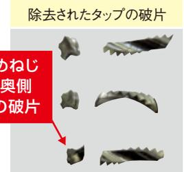
スパイラルタップのような溝がねじれたタップは、めねじにタップのランドが巻き付いているため、除去中でも動きにくく、途中でタップの破片が出にくい。そのため、ITRDはスパイラルタップ(ねじれ角35°以上)の除去に最適です。
