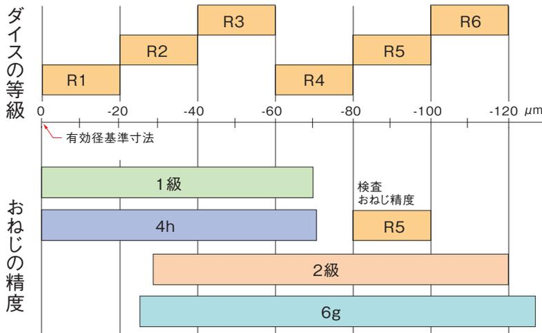
ダイス等級：R級はローリングダイスで加工された検査おねじの有効径公差域を示します。
