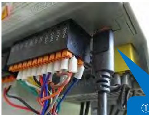
① PCとインバータをUSBケーブル(Standard A~mini B)で接続する
