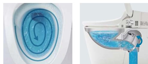
最低水圧0.05MPa(流動時)*3 トラップが回転し排水するターントラップ方式でスッキリ流し切ります。
