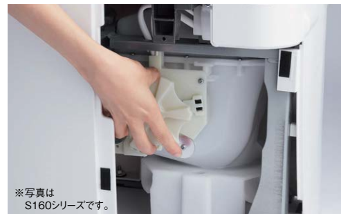
ターントラップ方式 普段は、排水路が上を向き、便器内に水をためていますが、洗浄時は、排水路が下向きに回転し、一気に排水。 さらに約55dB(A)の気になりにくい洗浄音(通常の話し声くらい)を実現。*2 ※写真の便座(V専用トワレ)は、Sシリーズです。
