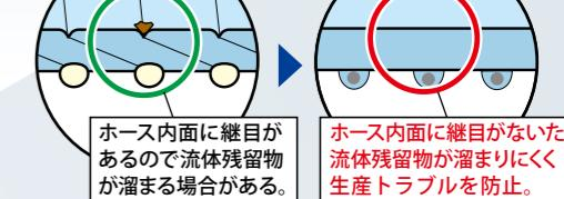
ホース内面に継目があるので流体残留物が溜まりにくく生産トラブルを防止。
