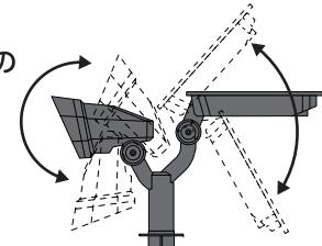
①本体と杭をつなげて庭先や家庭菜園などの土にさし、ヘッドとソーラーパネルの向きを調整して使用してください。ソーラーパネルは直射日光が十分に当たるように角度を調節してください。
