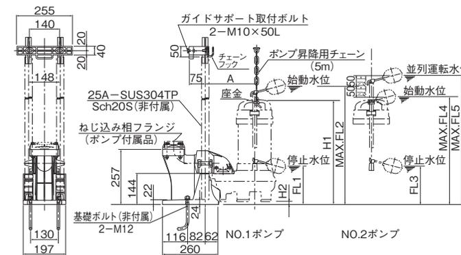
※ガイドフック取付ボルトは水中ポンプ付属品を使用します。
