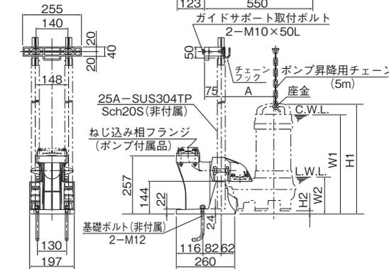
※ガイドフック取付ボルトは水中ポンプ付属品を使用します。
