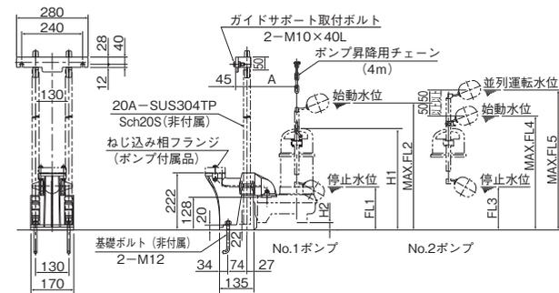
※ガイドフック取付ボルトは水中ポンプ付属品を使用します。
