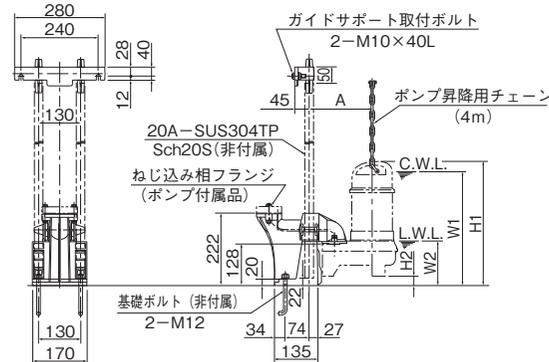
※ガイドフック取付ボルトは水中ポンプ付属品を使用します。
