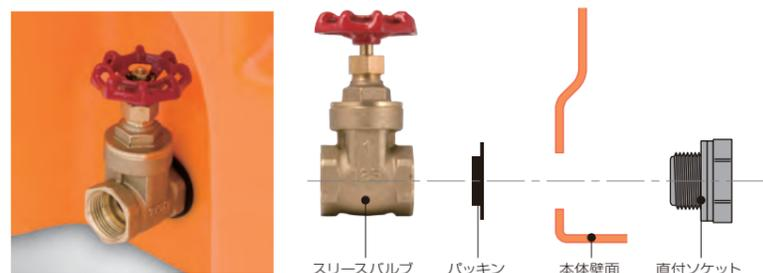
タンクを中心下部に位置するスリースバルブ取付用スペースの壁面に穴加工を施して、直付ソケットとスリースバルブで壁面を挟み込むようにして締め付け固定します。工場にて取り付け、出荷します。
