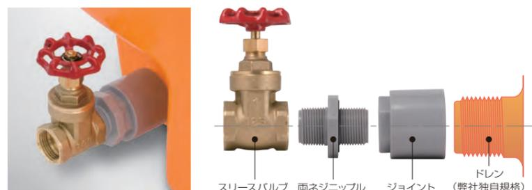
ドレンにジョイント、ニップルを利用してバルブを接続することができます。輸送中に破損の恐れがあるため部品類はタンクと同送致します。ドレンキャップを外して取付してください。（ニップルにはシールテープをご使用ください）
