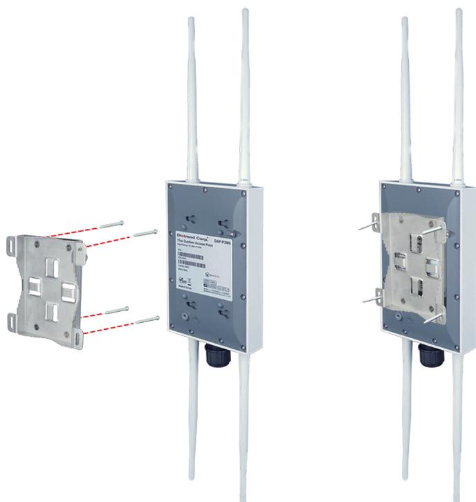
(※) ブラケットと本体を固定するためのビスは出荷時本体に取り付けられていますので外してご使用ください。
