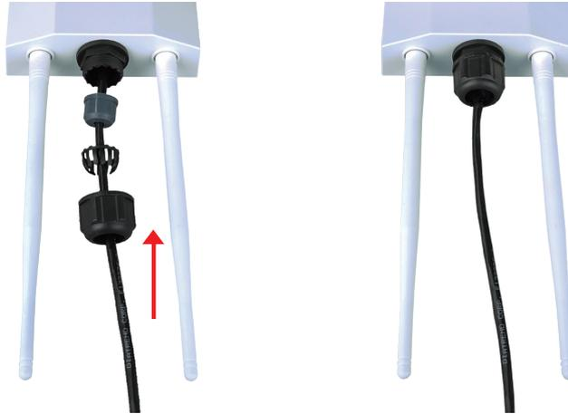
(※) LAN ケーブルの適合外径は 4.5～6.5mm です。範囲外の LAN ケーブルを使用すると防塵防水性能が保てません。また LAN ケーブルのコネクタにカバーなどがあると防水コネクタが閉まらない可能性があります。
