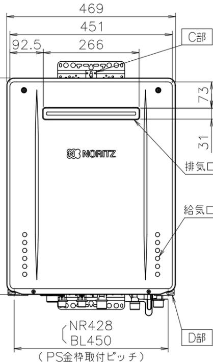
適応金枠 標準設置形Ⅱ型
