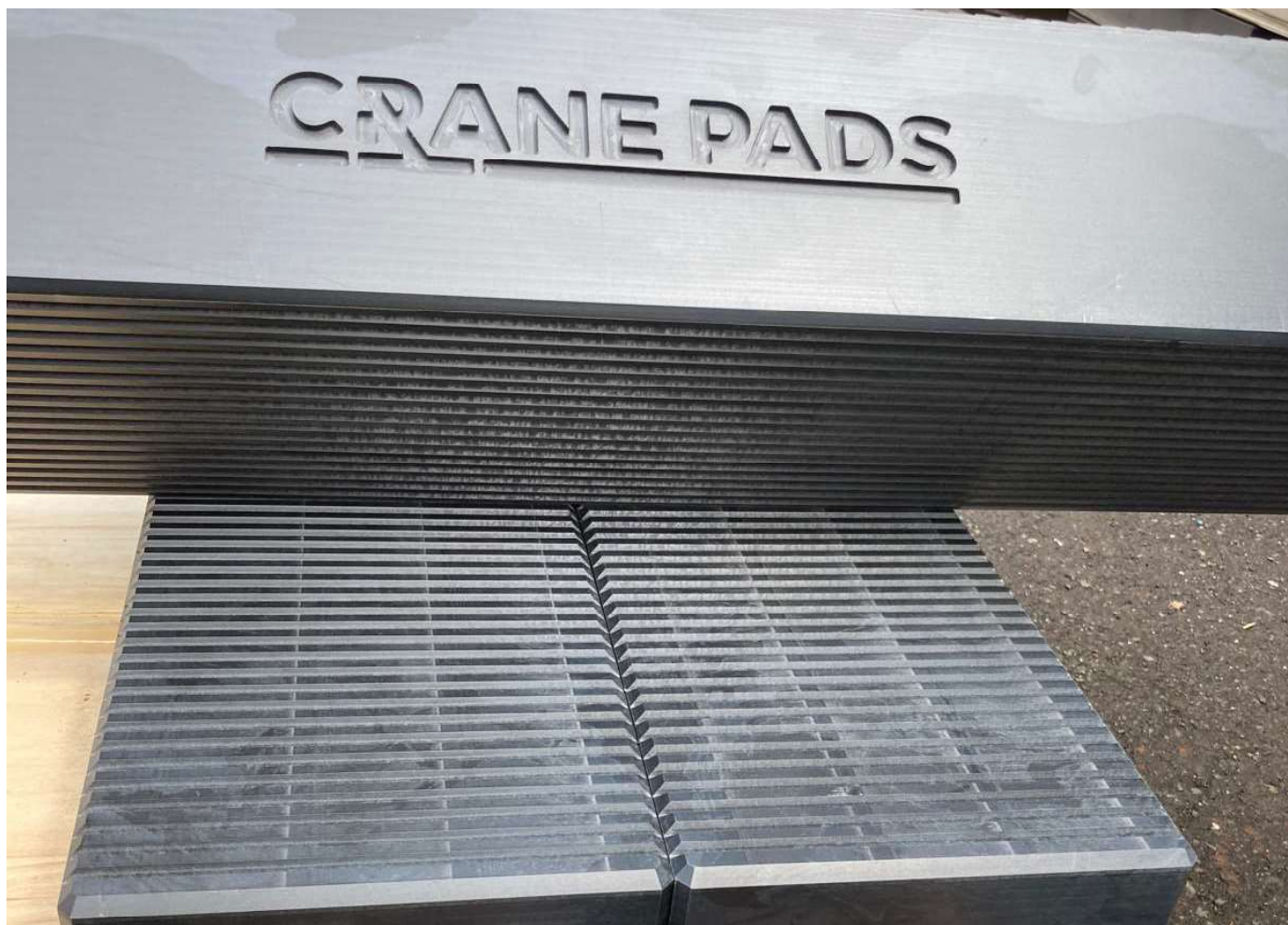
90度違う方向の溝は井桁に重ねた際、ヨコ溝(ブロック下面)とタテ溝(ブロック上面)がかみ合い、スリップを防止
