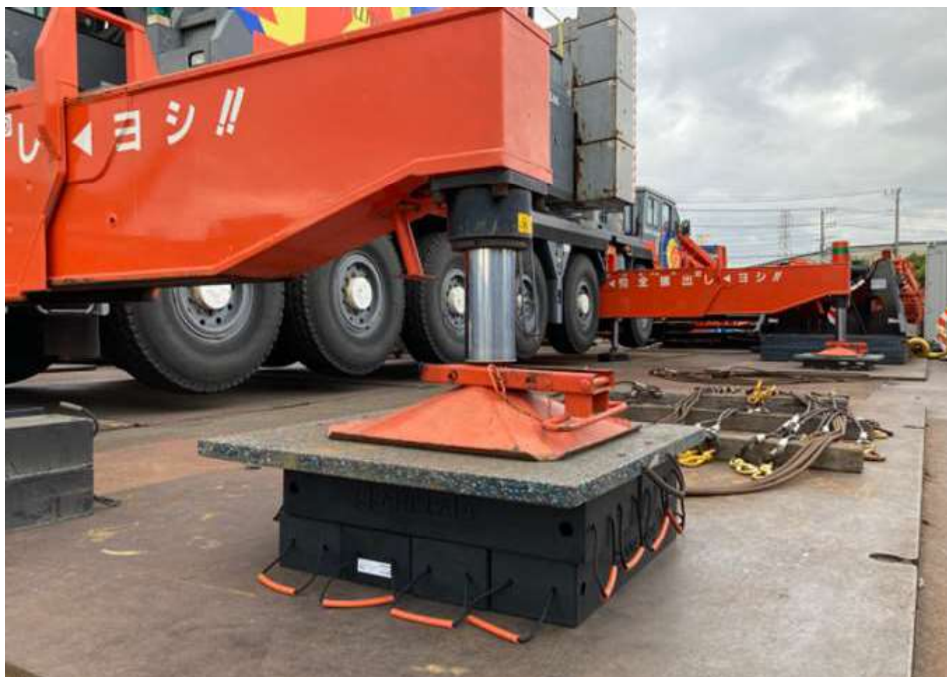
90度違う方向の溝は井桁に重ねた際、ヨコ溝(ブロック下面)とタテ溝(ブロック上面)がかみ合い、スリップを防止
