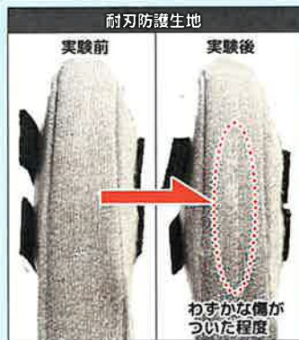
耐刃防護生地 実験前 実験後 わずかな傷が ついた程度
