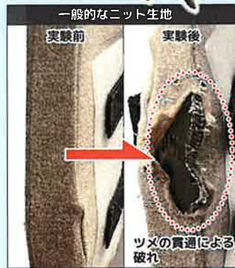
一般的なニット生地 実験前 実験後 ツメの貫通による 破れ
