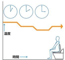
使用頻度によって温度を下げ、最大限の節電効果を発揮する節電方式です。休日はもちろん、使用頻度の低い深夜の時間帯はヒーター(温水・便座)を切って節電します。
