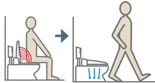
着座時間に応じて大・小切替。便座から立ち上がると自動で洗浄するので流し忘れの心配もありません。一定時間使用しないと自動で洗浄する設備保護洗浄機能付です。
