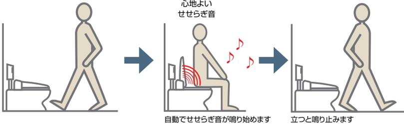
音消し目的の無駄な洗浄を防ぐために、便座に座ると自動的にせせらぎ音が鳴り始める「オート擬音」を内蔵しています。
