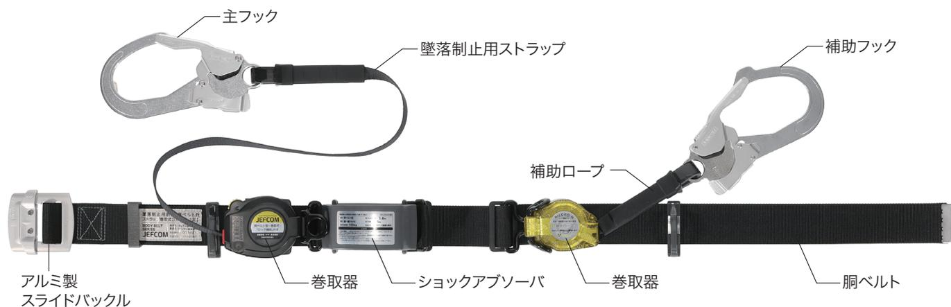
⚠️注意 補助ロープは、移動時のフック掛け替えの際に、無胴網状態が発生することを防ぐためののみご使用ください。
