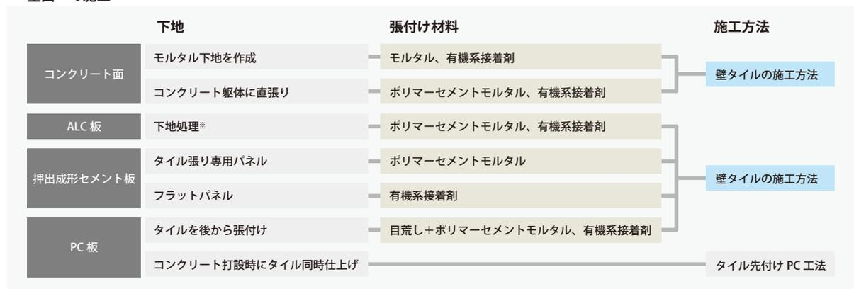
\*吸水率が高くドライアウトしやすいため、調整剤やポリマーセメントモルタルで処理してください。
