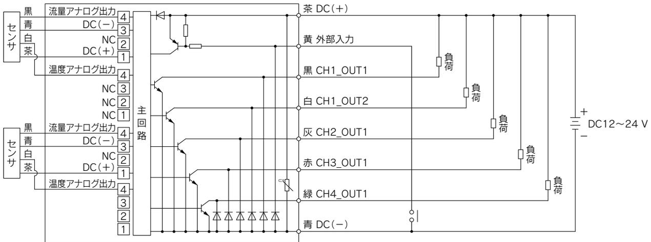
※温度センサ付デジタルフロースイッチで流量アナログ出力と温度アナログ出力を接続する場合はセンサ1台に対してe-conを2個使用してください。
