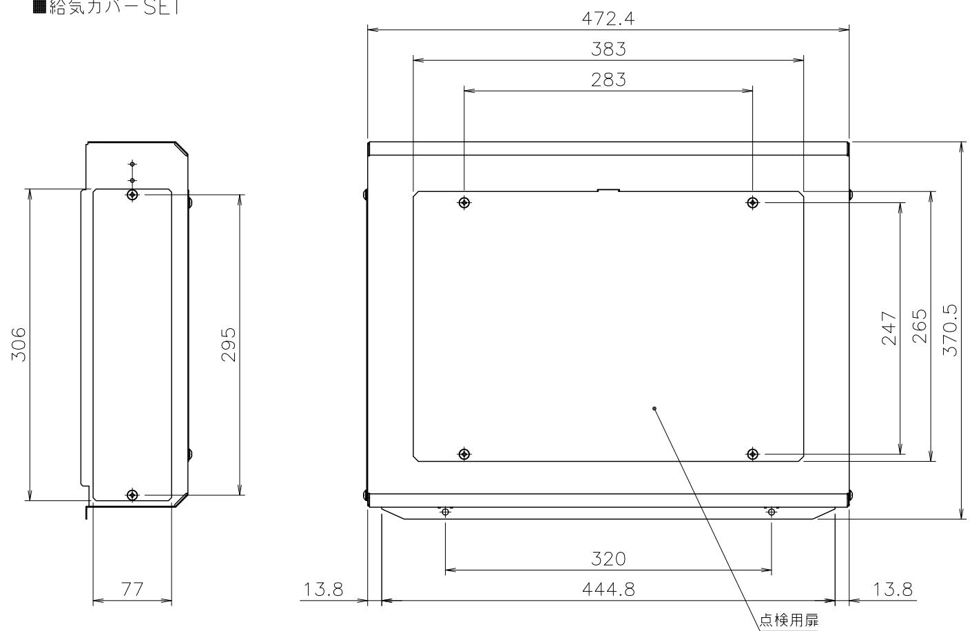
■取り付け参考図（右側給気の例）
