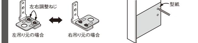
3. 下軸受けの上の2か所を仮固定し、傾きを調整する。
