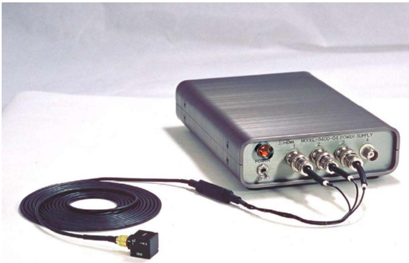
写真は、4チャンネル電源と3軸加速度センサを組み合わせた例です。
