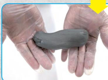
色が均一（グレー）になれば接着や穴埋めする部分に塗り付け、硬化するまで動かさない。
