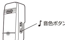
④送信器を押します。→選択した音色がもう一度鳴り、送信器の音色が設定されます。
