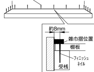
**【注意】** ●棚板は押えつけながら、棚板が受棧から浮かないように適宜、フィニッシュネイルを増し打ちし、固定してください。
