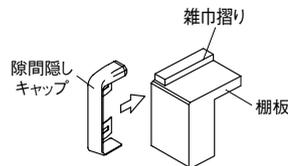
雑巾摺り(長)・(短)を取付け箇所の寸法に合わせてカットし、フィニッシュネイル L=35mm（現場調達）で雑巾摺りを固定してください。（300mmピッチ以内で固定してください。）
