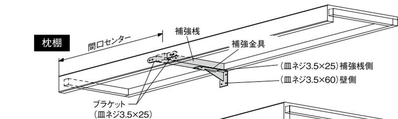
●中段は、扉の使用勝手に合わせて側壁から3尺以上の位置に補強棧・補強束を取付けてください。
