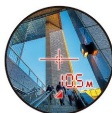
直線（傾斜）距離 トゥルーパルスから 目標物までの直線距離
